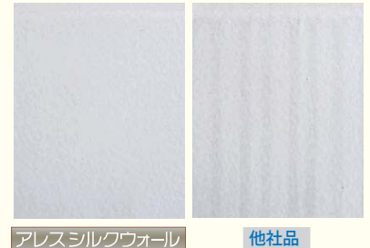
ばく露試験(耐汚染性) 東京で6ヶ月間(2013年5月~11月)での耐汚染性
